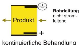
**Abb. 8:** Prinzip der kontinuierlichen Keimreduktion mittels pulsierender elektrischer Felder
